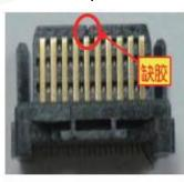
3、端子压伤及沾污(压伤超过0.1mm x0.1mm) Terminal Crush & Contamination Detection(Terminal Crush > 0.1mm x0.1mm)
